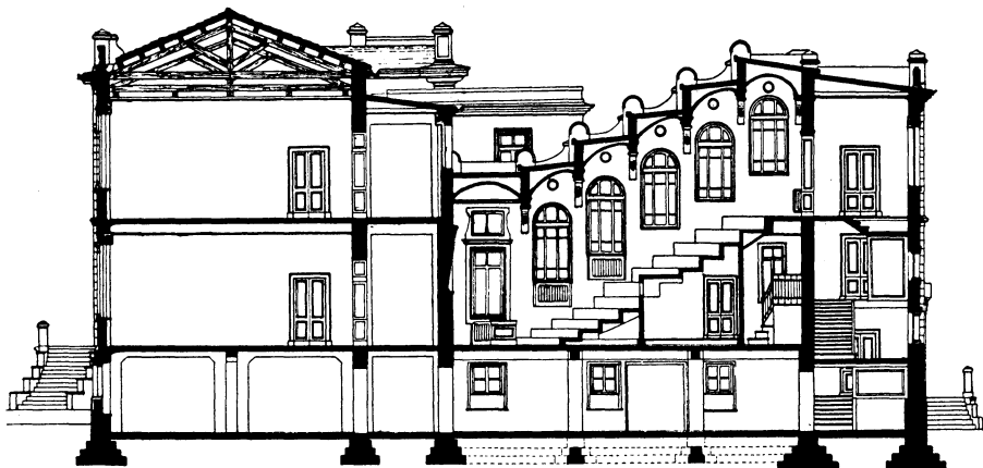
FIG. VI. - Spaccato verticale dell'edificio in corrispondenza dell'Aula.
